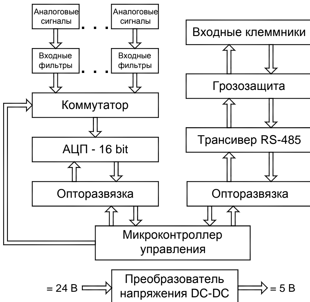
Рис. 1.5.4 Функциональная схема контроллера МКСА-03 М.
