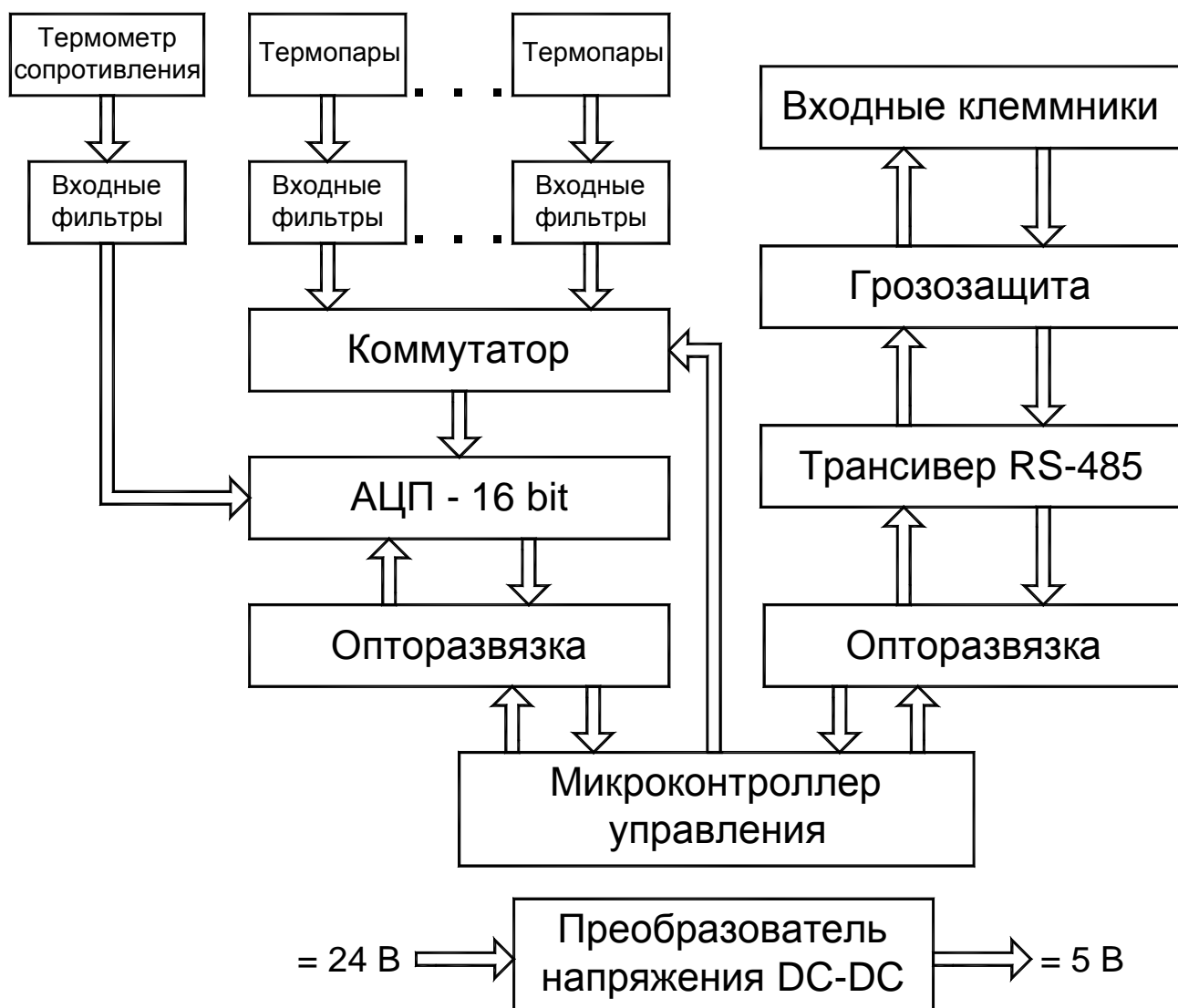
Рис. 1.5.5 Функциональная схема контроллера ввода аналоговых сигналов МКСА-06 М.
