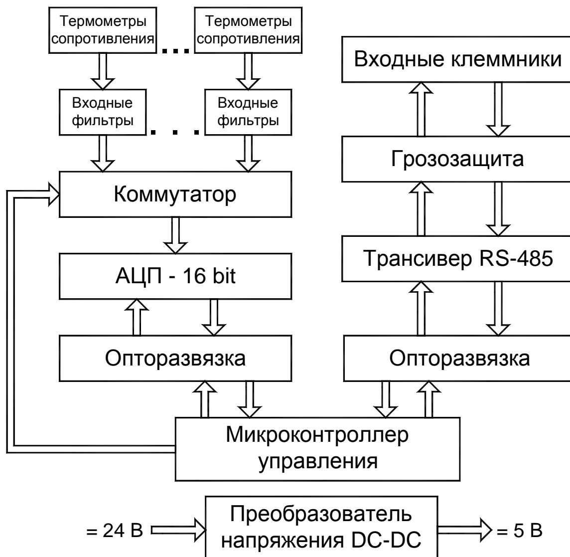
Рис. 1.5.6 Функциональная схема контроллера ввода аналоговых сигналов МКСА-07 М.
