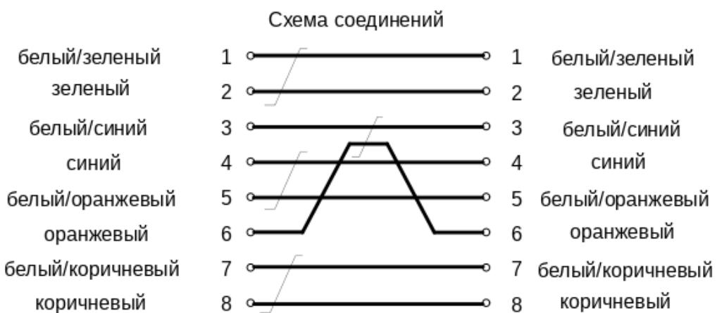
Индикация подключения к 100Mb Ethernet
